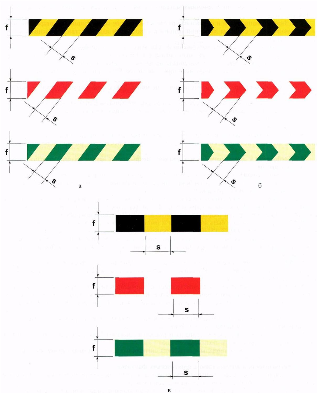
*a* - расположение полос наклонно; *б* - расположение полос зигзагообразно в виде «елочки»; *в* - расположение полос прямо (вертикально или горизонтально), *f* - поперечный размер сигнальной разметки, *s* - ширина полосы сигнального цвета.
