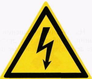
A yellow triangular warning sign with a black border. Inside the triangle is a black lightning bolt symbol.                                                                                                    | Опасность поражения электрическим током   | На опорах линий электропередачи, электрооборудовании и приборах, дверцах силовых щитков, на электротехнических панелях и шкафах, а также на ограждениях токоведущих частей оборудования, механизмов, приборов |
