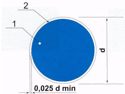
*d* - диаметр круга; 1 - основная поверхность; 2 - кант
