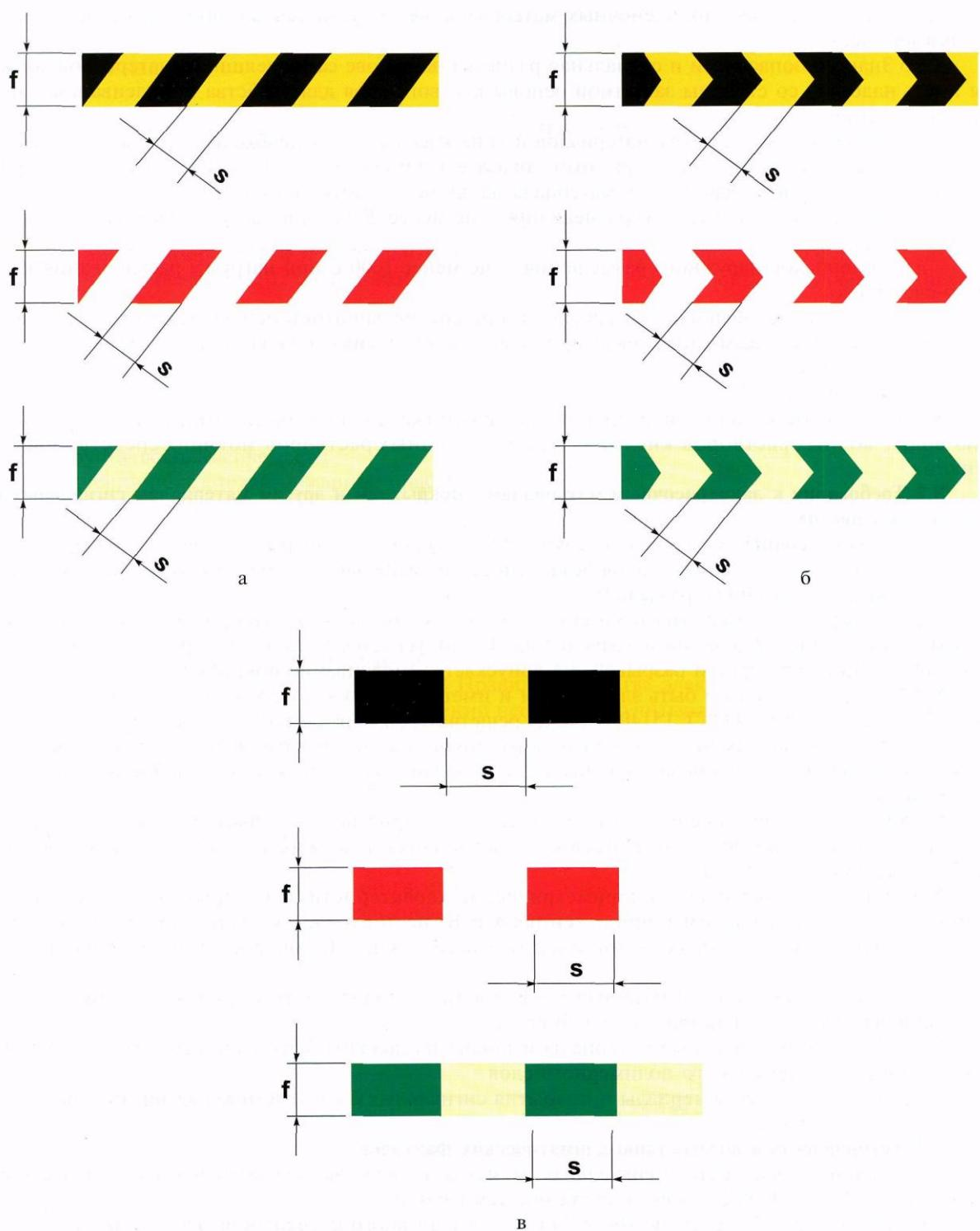
*a* - расположение полос наклонно; *б* - расположение полос зигзагообразно в виде «елочки»; *в* - расположение полос прямо (вертикально или горизонтально), *f* - поперечный размер сигнальной разметки, *s* - ширина полосы сигнального цвета.
