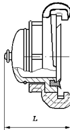
Рисунок 9 — Всасывающая головка-заглушка
