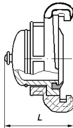
Рисунок 6 — Напорная головка-заглушка
